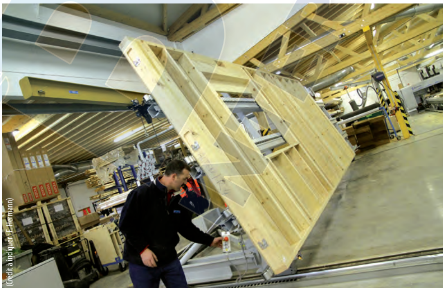
La pose des isolants s'effectue après retournement automatique des murs assemblés.
